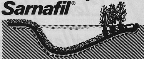
Die grüne Sarnafil-Kunststoff-Dichtungsbahn wurde speziell für die Abdichtung von Teichen und Biotopen geschaffen. Sie genügt den hohen Anforderungen (mechanische Beanspruchung, Wurzelbeständigkeit usw.) und passt sich der natürlichen Umgebung farblich an. Sarnafil-Abdichtungsbahnen werden nach Mass im Werk (bis ca. 80m<sup>2</sup>) angefertigt, bei grösseren Anlagen auf der Baustelle.
