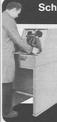
WSL, die unentbehrliche Schärfmaschine mit Wasserkühlung für Ihre Stechbeitel und Hobelisen. Eine wirkungsvolle Nassschleifeneinrichtung verhindert jegliche Erwärmung und verhilft zu längeren Standzeiten. Kein Funkenwurf ausserhalb der Maschine. Schnellstes Nachschärfen dank gleichbleibender Maschineneinstellung bis zur vollständigen Abnutzung der Schleifscheibe.
