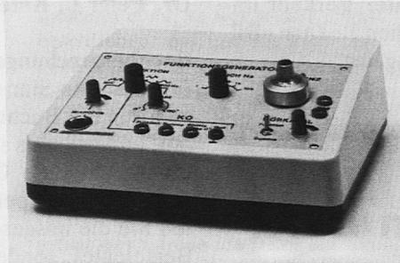
Dank diesen Zusatzfunktionen können unter anderem folgende interessante Demonstrationen durchgeführt werden: Schwebungen, Resonanzversuche, Signalverlauf verschiedener Schallquellen wie z.B. Musikinstrumente, Lissajous-Figuren und Interferenzen, phasenstarr oder freilaufend, Induktionsversuche usw.
