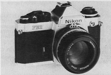
Das Geheimnis der Nikon FE2 ist der neuartige Schlitzverschluss, eine Nikon-Entwicklung mit Verschlussvorhängen aus Titanium. Hier haben Nikons Konstrukteure ein kleines Wunder vollbracht. Unter Verwendung hauchdünner Titaniumfolien gelang es ihnen, das Gewicht der Verschlussvorhänge stark herabzusetzen. Damit aber die mechanische Festigkeit erhalten bleibt, wurde in die Verschlussfolien ein Wellenmuster eingezüht.
