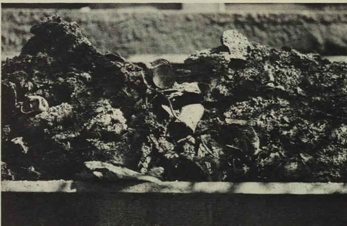
**14. Schlacke:** Natürlich entsteht in der Kehrichtverbrennungsanlage aus den nicht brennbaren Materialien (Metalle, Porzellan usw.) auch Schlacke. Es geht also nicht der ganze Abfall in die Luft über.
