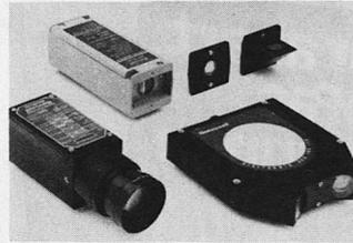
Für die Inbetriebnahme genügt ein Schraubenzieher. Oszilloskop oder Messgeräte sind meist nicht erforderlich. Als Ausgang stehen 4 NPN-Transistor-Schaltausgänge à 100 mA, 0...5 V- oder 4...20 mA-Analogsignal sowie RS232-C- oder RS422-Schnittstellen zur Auswahl.
