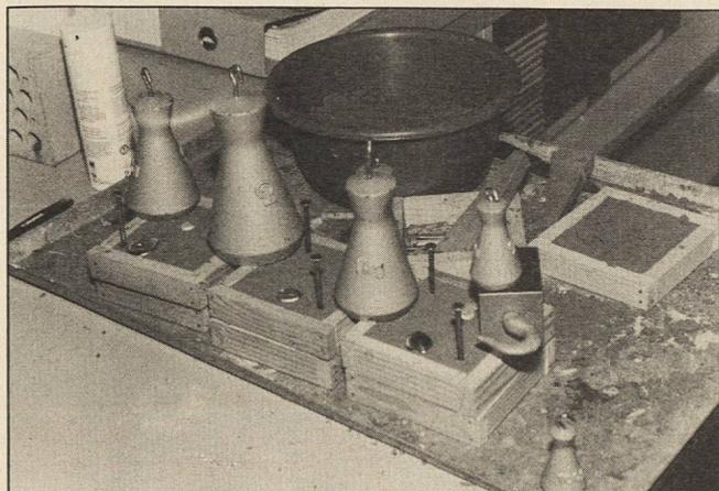
Die Gewichte verhindern, dass der Auftrieb des Giessmetalls das Formoberteil abhebt.
