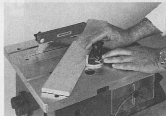
Genauere Winkelschnitte dank präzisiertem Gehrungsanschlag.
