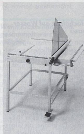
Für den Werkraum bietet IDEAL ebenfalls ein ausgezeichnetes Hebelschneidermodell an. Die IDEAL 1080 U ist die Standard-Werkstoffschneidemaschine mit 80 cm Schnittlänge für Schulen und Werkräume.
