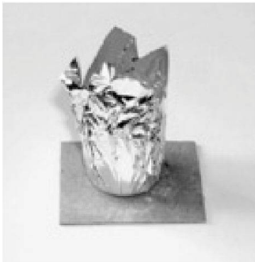
Abb. 10: Die Aluminiumform wird mit Hausmehrzweckklebstoff bestrichen und auf einem Kartonkärtchen fixiert.
