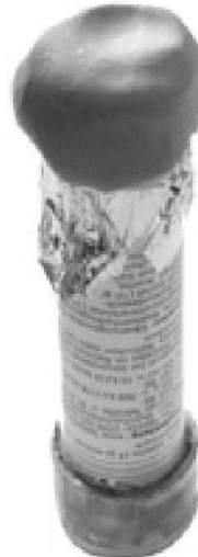
Abb. 11: Die Aluminiumform wird mit Plastilin fixiert.
