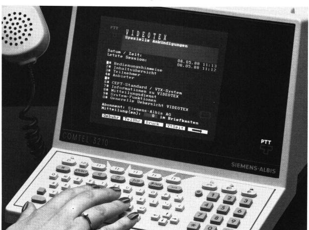
Telefonieren einerseits, Daten-, Text- und Bildaustausch im Videotexbetrieb andererseits oder gleich beides zugleich: Das COMTEL® 3210 von Siemens-Albis stellt das ideale Instrument für eine umfassende Telekommunikation dar. An jedem analogen Telefonanschluss anschliessbar, lässt es sich als Komforttelefon mit Namenregister von über 500 Zeilen wie auch als Videotex-Endgerät mit Makroregister für
