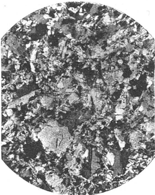
No 6. Aplite en filon dans les roches vertes. Mine Remington. La coupe montre les petites lamelles de muscovite calées entre les cristaux d'orthose, de plagioclase et de quartz. Structure granitique. Objectif Zeiss C oculaire O.
