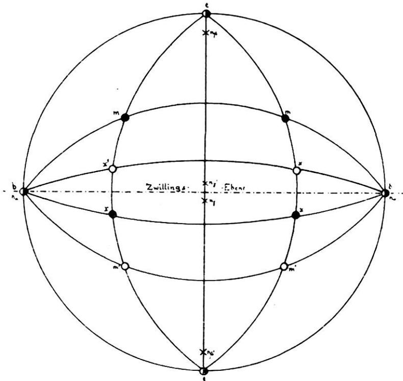
Fig. 2. Stereographische Projektion des Zwillinges von Fig. 3b.
