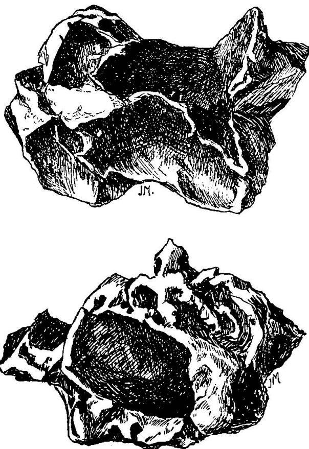
Fig. N o VIIa et b. — Pépites provenant des Pyroxénites montrant les cloisons et les cavernes provenant de la désagrégation du Pyroxène moulé par le Platine.
