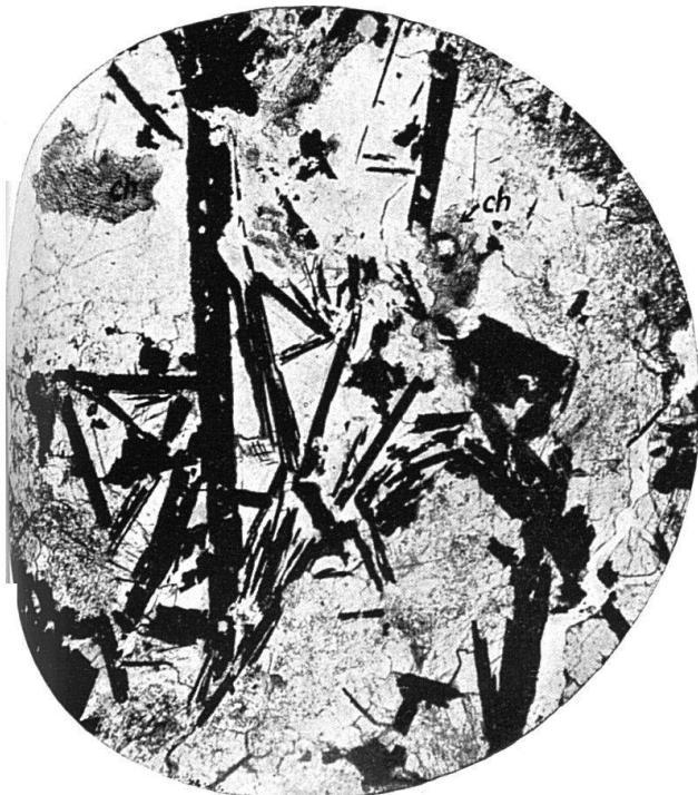
Phot. 10 a Eisenglanz führender Braunspatgang, Kaltenberg, Turtmanntal Eisenglanz in Braunspat, mit Chlorit (ch) Dünnschliff 32 ×
