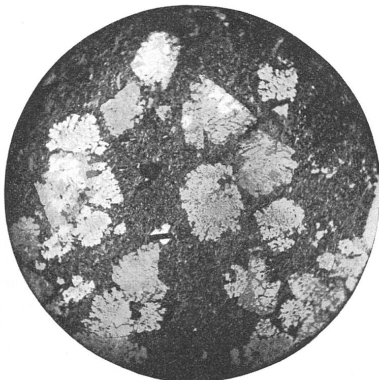
Fig. 2. Lamprophyr mit Biotit als Grundmasse und «Orthoklas-einsprenglingen».
