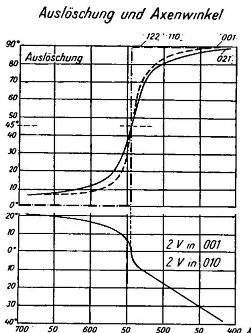
Fig. 2. Abhängigkeit der Auslöschungsschiefe der Wachstumsbereiche  $\langle 122 \rangle$ ,  $\langle 110 \rangle$ ,  $\langle 001 \rangle$ ,  $\langle 021 \rangle$  und des Achsenwinkels von der Wellenlänge des Lichtes
