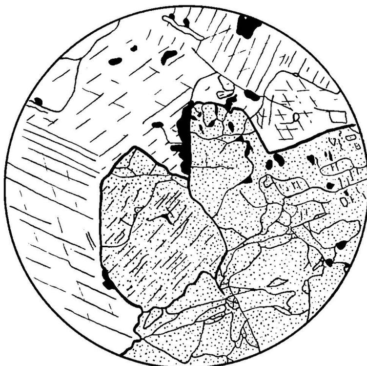
Fig. 2. Dünnschliffbild von Calcit-Datolithaggregat, punktiert Datolith, schraffiert Calcit
