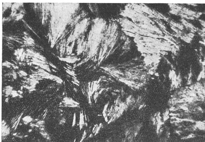
Fig. 12. Bel exemple de structure arborescente-sphérolitique. Diabase du Col des Gêts. Haute Savoie. Nicols croisés. Gross.: 65 \times .
