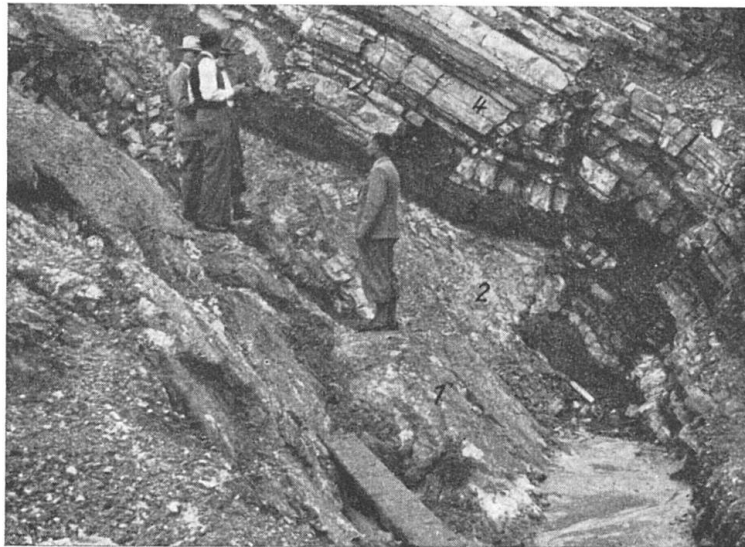
Fig. 4. Tonaufschluss im Steinbruch Schivanoia 1 Liegendes, 2 Ton, 3 Sandlage, 4 Hangendes (Dolomit). Rechts Störung Photo v. M.
