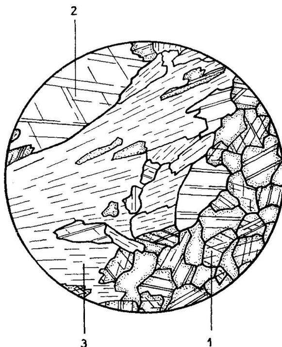
Fig. 3. Kalzitneubildung bei der Tremolitreaktion im Dolomit
