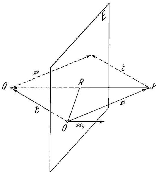
Fig. 8. Spiegelung des durch seinen Ortsvektor  $\mathbf{v}$  gegebenen Punktes  $P$  an einer durch ihren Normalvektor  $\mathbf{n}$  bestimmten Ebene  $E$ . Berechnung des Ortsvektors  $\mathbf{g}$  des gespiegelten Punktes  $Q$ .
