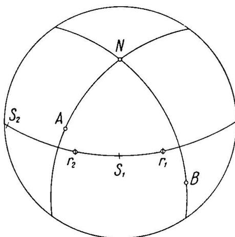
Fig. 10. Fresnel'sche Konstruktion in neuer, für die vektorielle Behandlung geeigneter Variante. Die beiden der Wellennormalrichtung  $N$  zugeordneten Schwingungsrichtungen  $S_1$  und  $S_2$  sind die Halbierungspunkte der durch  $r_1$  und  $r_2$  eingeschlossenen räumlichen Winkel.  $r_1$  und  $r_2$  sind ihrerseits die Pole der beiden durch den Pol von  $N$  und diejenigen der beiden optischen Achsen  $A$  und  $B$  gelegten Grosskreise.
