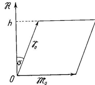
Fig. 12. Steht die Bezugsfläche  $M$  normal zu  $F$ , so genügt die Betrachtung des durch die Einheitsvektoren  $\mathfrak{M}_0$  und  $\mathfrak{S}_0$  aufgespannten Parallelogrammes an Stelle des Parallelepipeds von Fig. 11.
