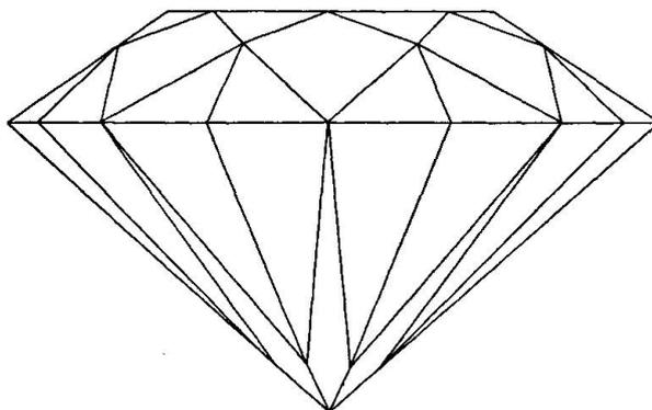
Fig. 2. Käuflischer Rutilbrillant (Aufriss)
