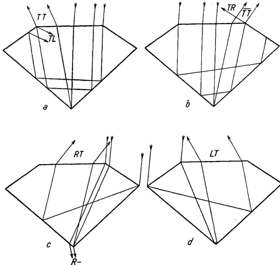
Fig. 3. Strahlenverläufe im Rutilbrillant bei Lichteinfall unter  $V = 5^{\circ}52'$ .
