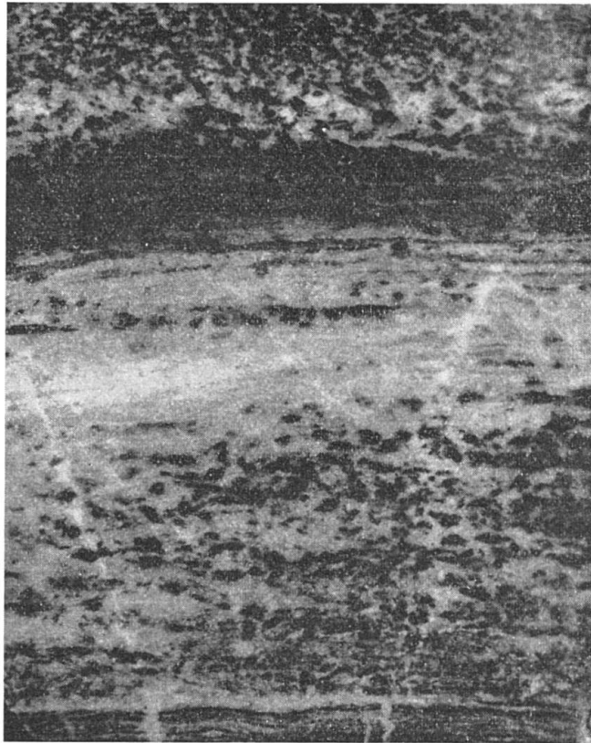
Fig. 7. Polierter Anschlag aus der Randzone eines 50 cm grossen zonierten kalksilikatführenden Einschlusses vom 1. Typus in den schiefrigen Paragneisen, rechtes Ufer der Lisora auf 312 m Höhe. Vergrösserung 1 : 1,25. Zuoberst Übergangzone des Einschlusses zum Nebengestein (massiger Granat und Hornblende führender Biotit-Plagioklasgneis). Dann folgt eine cm-mächtige hornblendereiche Zone. Die untere Hälfte des Anschliffs besteht aus einer weisslichgrauen bis fleischfarbigen Grundmasse (Quarz, aus Plagioklas hervorgegangener Muskowit, Granat, Diopsid) mit grünen Hornblendeinsprenglingen. Zuunterst setzt wieder eine Hornblende-lage ein.
