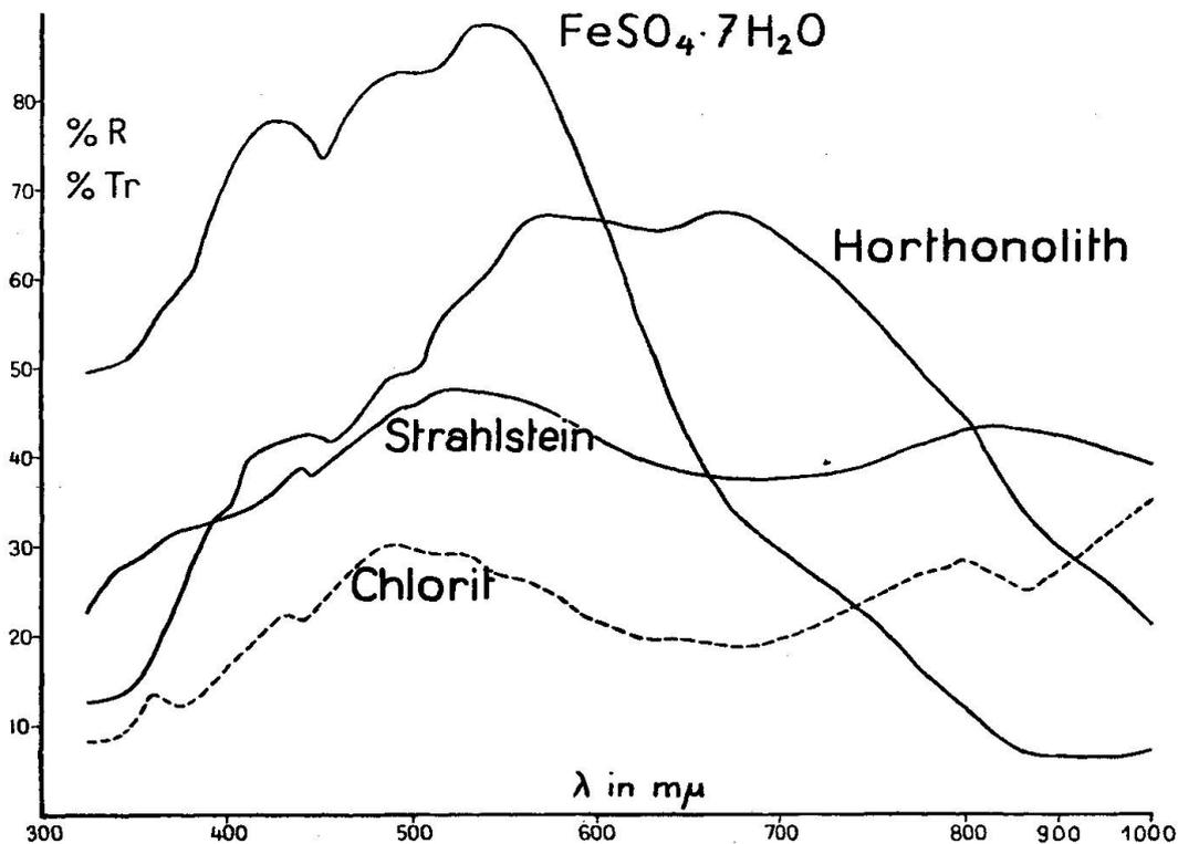
Fig. 11 gibt eine Zusammenstellung der Reflexion einiger grüner Mineralien und die Reflexionskurve von  $\text{FeSO}_4 \cdot 7\text{H}_2\text{O}$ . Chlorit ist in Transmission gemessen <sup>3)</sup>.
