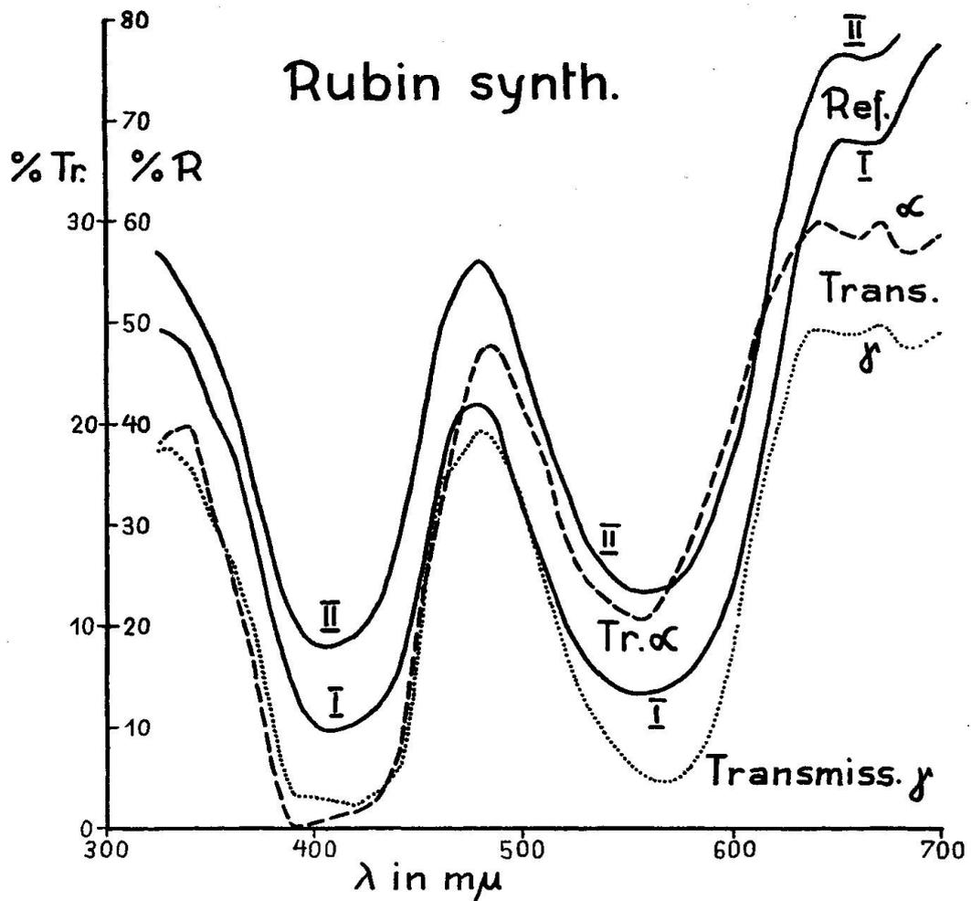
Fig. 5. Transmissionsmessungen für die Schwingungsrichtungen  $\alpha$  und  $\gamma$  von synthetischem Rubin (gebrochene Linien) im Vergleich zu Reflexionsspektren des Pulvers.
