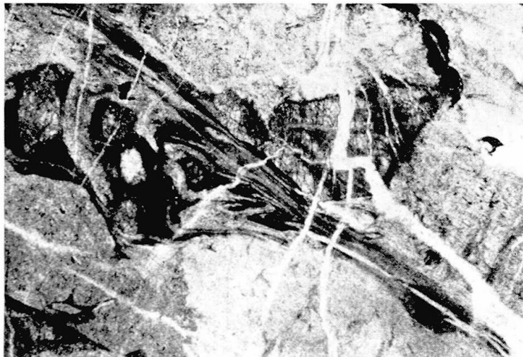
Fig. 8. Bewegungsbahn in einem Peridotit. Vergr. 27\times . Ohne Analysator. Fundort: Nördlich der Wasserscheide wie Fig. 3. Erklärung im Text.
