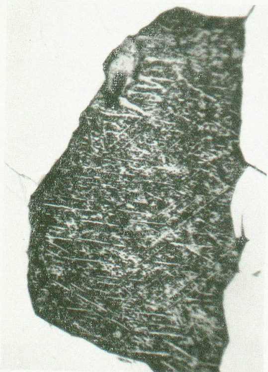
Fig. 6. „Einschluss“ von Schapbachit im Pyrit von Gondo. Geätzter Anschliff. 750 \times , Ölimmersion.
