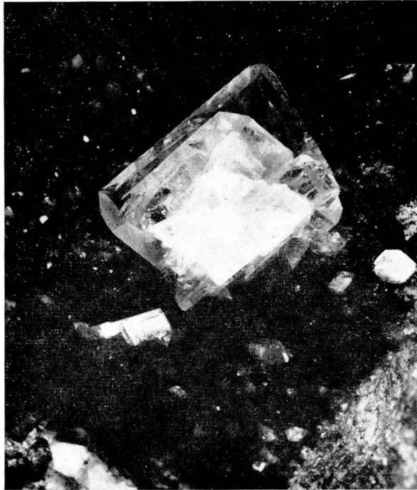
Fig. 2. Adular aus der Cavradischlucht (Tavetsch). Klarer Kristall, nach dem Bavenogesez (021) verzwillingt. Die Kantenabstumpfungen sind  $z(130)$ . In der Mitte sitzt dem Kristall, ebenfalls in gesetzmässiger Verwachsung, ein kleineres Individuum auf. Vergrösserung  $2\times$ .
