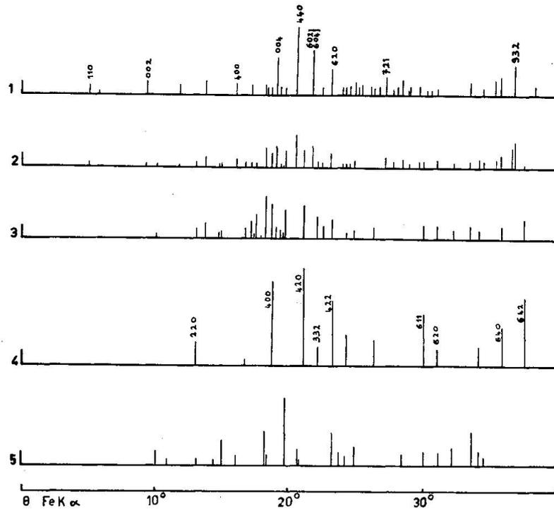
Fig. 2. Strichdiagramme aus Pulveraufnahmen mit einer Guinier-Kamera nach de Wolff. Nr. 1: Vesuvian III; Nr. 2: Vesuvian III, erhitzt bis 970° C; Nr. 3: Vesuvian III erhitzt bis 1060° C; Nr. 4: Grossular (Zermatt) zum Vergleich; Nr. 5: Gehlenit (Tirol) zum Vergleich.
