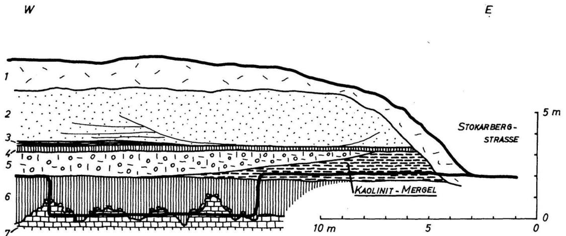
Fig. 1. Aufschluss der Baugrube Stokarbergstrasse Schaffhausen, Herbst 1960.
