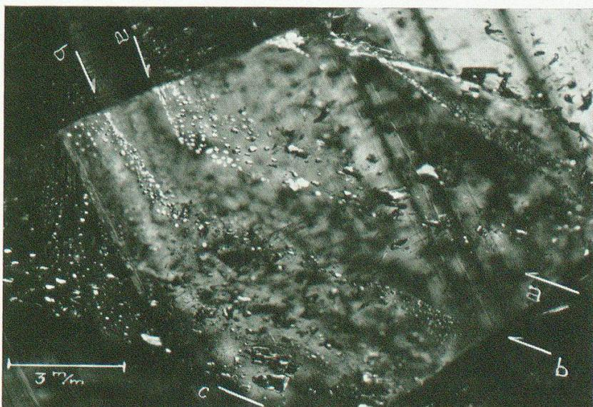
Fig. 16. Lagenweise angereicherte Flüssigkeitseinschlüsse a, b und c. Liegen Translationsflächen parallel. (Normales Rhomboeder.) Translationszone in Quarz (rechts) der Fig. 15.
