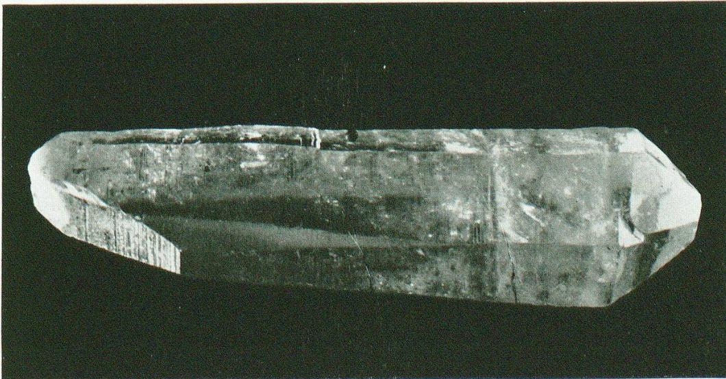
Fig. 14. Bipyramidaler Quarz mit prismatischem und trigonalem Ende.
