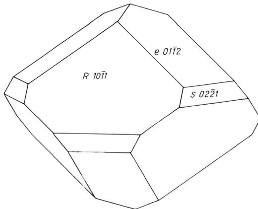
Fig. 2. Formentwicklung am Chabasit vom Chrüzlistock. Idealisierter Einzelkristall.
