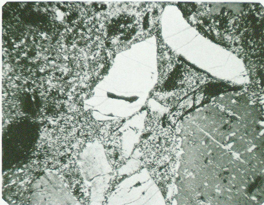
Photo n° 15. Pâte quartzo-séricitique et feldspathique renfermant des débris de quartz et de feldspath potassique. Echantillon Roffna n° 11. G = 28 ×. Nicols croisés.
