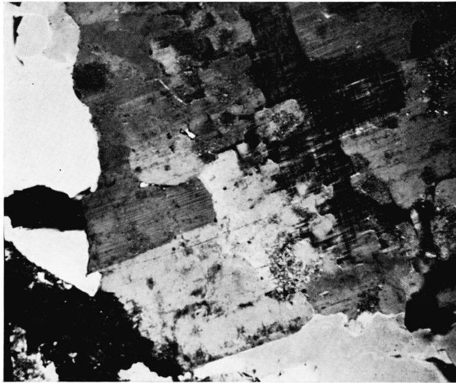
Abb. 1. Massiger Grimsel-Granodiorit. Vergr.  $25 \times$ . Nicols X. Scharf gegitterter Mikroklin verdrängt Plagioklas. Druckschacht KW Oberaar.
