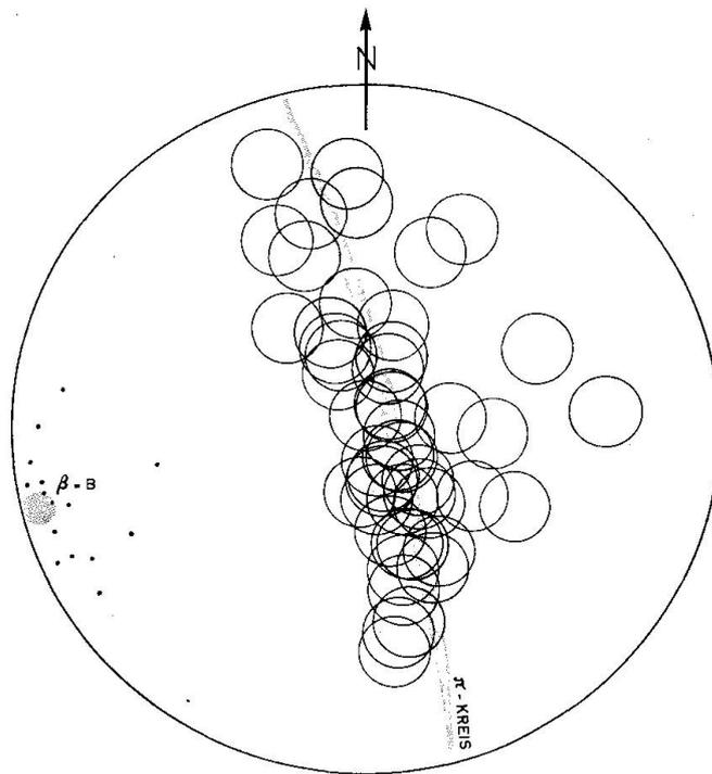
Fig. 25. Flächentreue Azimutalprojektion von 50 s-Flächen und 16 Lineationen aus dem Gebiet E von Masera. Projektion auf obere Halbkugel. Pole auf s-Flächen: 1 %-Kreise.  $\pi$ -Kreis gerastert; Lineationen: Punkte. Pol auf  $\pi$ -Kreis = B-Achse =  $\beta$ -Achse = B-Achse (gerasterter Punkt).
