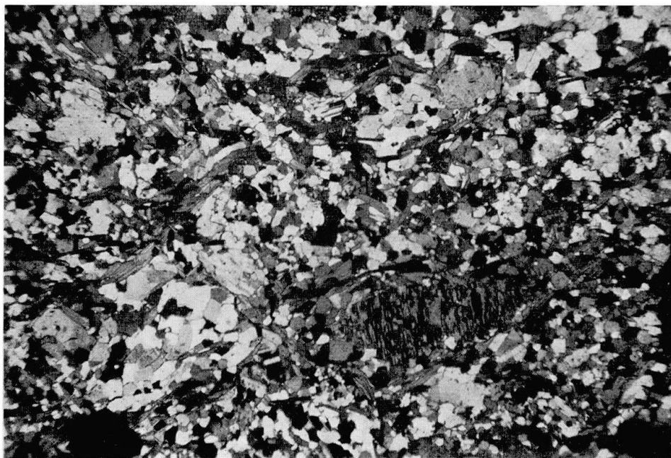
Fig. 5. Quartzite feldspathique séricitique arkosique, n o 238. Lumière polarisée. G = 20 × .
