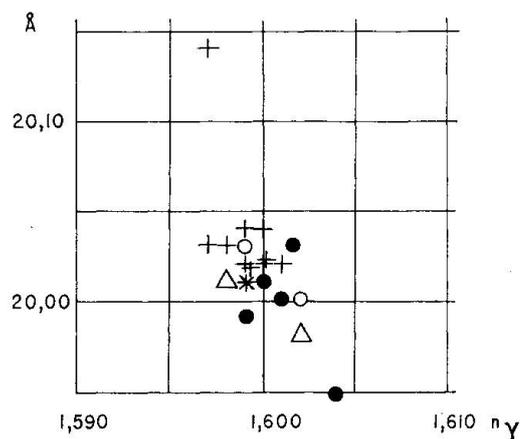
Fig. 2 bringt in graphischer Darstellung den Zusammenhang zwischen  $n_\gamma$  und  $\text{Fe}^{+3}$ .
