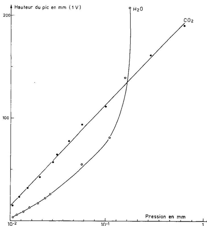
Fig. 2. Courbes d'étalonnage de l'eau et du CO<sub>2</sub>.
