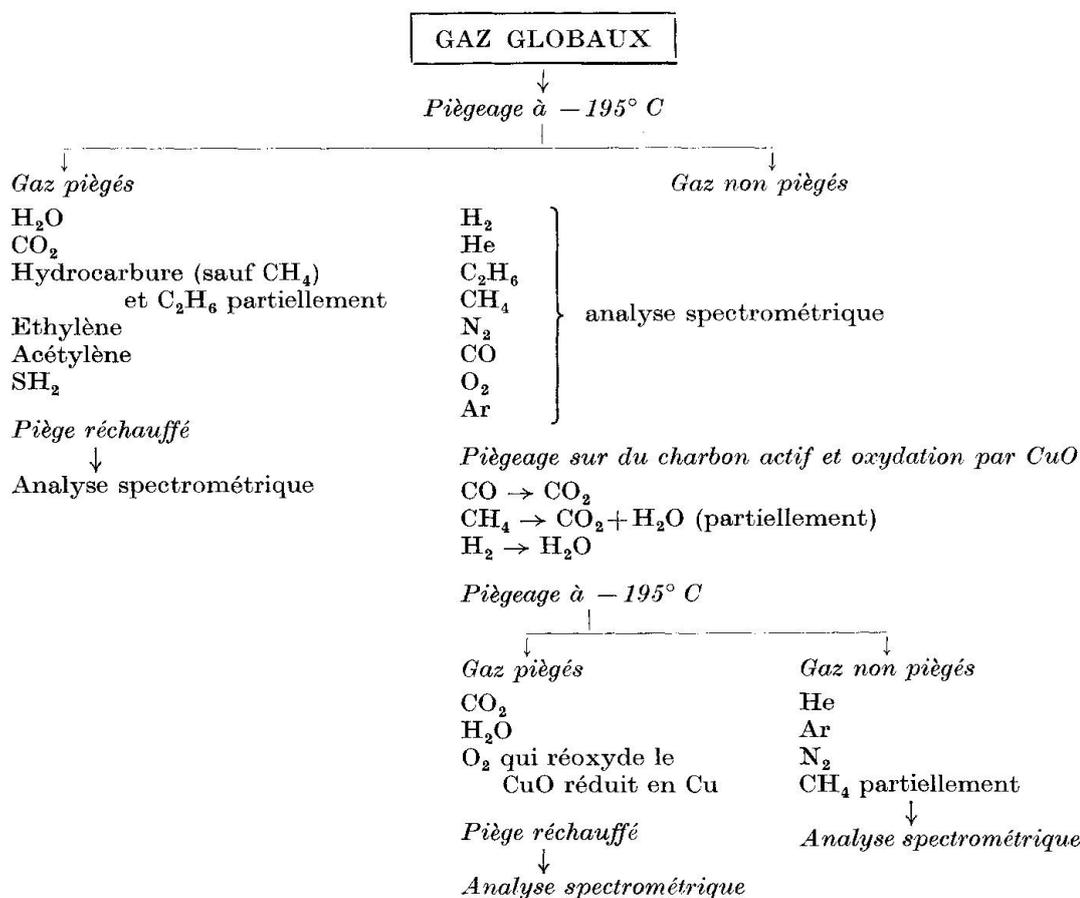
Tableau 3. Détermination par spectrométrie de masse de la composition des inclusions fluides.
