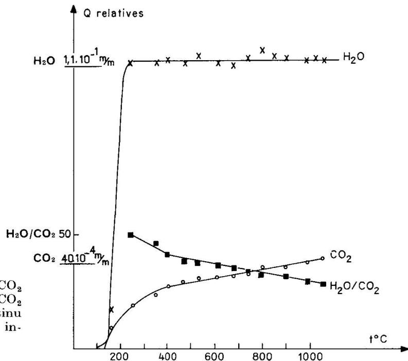
Fig. 4. Départ de l'H<sub>2</sub>O, du CO<sub>2</sub> et variation du rapport H<sub>2</sub>O/CO<sub>2</sub> au cours de l'étuvage continu jusqu'à 1100° d'un quartz à inclusions.
