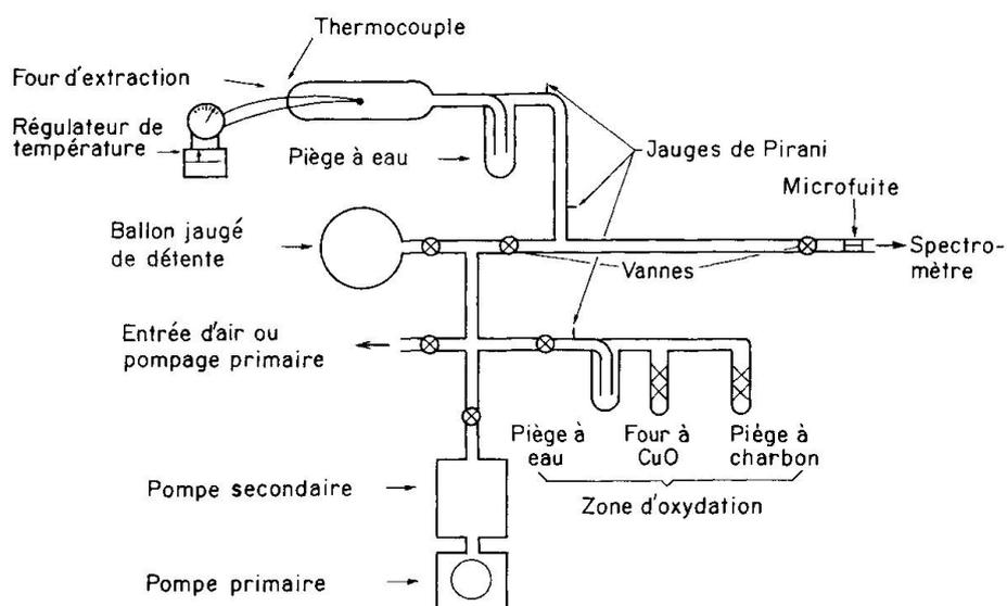
Fig. 1. Dispositif d'extraction et de séparation des gaz.
