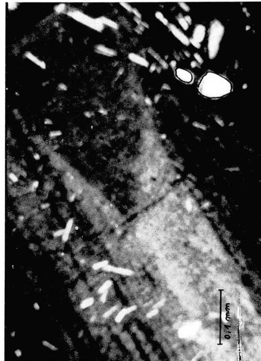
Fig. 6. Dünnschliffaufnahme vom Milarit von Val Strem, mit gekreuzten Nicols, geschnitten //c, umrandete Stellen zeigen die Orthoklaseinschlüsse.
