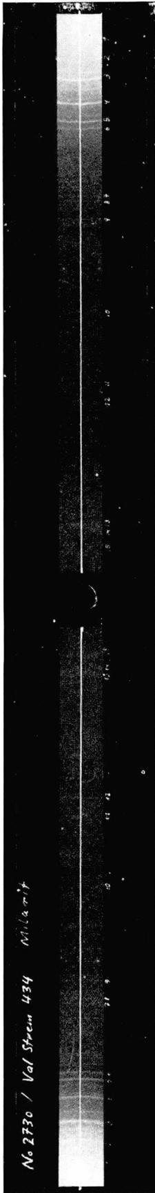
Fig. 5. Röntgendiagramm vom Milarit von Val Strem.
