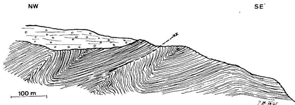
Fig. 51. Plissement avec chevauchement dans les marnes gréseuses du Miocène près de Dizàn.
