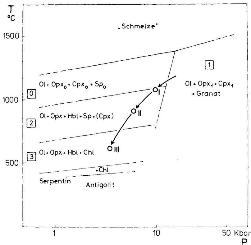
Fig. 8. Schematisches Faziesdiagramm orogentypischer Peridotite mit den verschiedenen Stadien der retrograden Metamorphose der Granatperidotite. I. Übergangsstadium zur Spinell-Hornblende-Peridotit-Fazies (Grundgebirge Mitteleuropas). II. Spinell-Hornblende-Peridotit-Fazies der mittleren Ivreazone. III. (über I. und II.) Stadium der Chlorit-Hornblende-Peridotit-Fazies (Westnorwegen, Alpe Arrami, Ultental).
