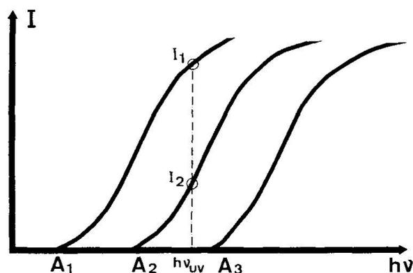
Fig. 2. Schematische Darstellung von Ausbeutekurven ( $I$ ) der Photoelektronenemission in Abhängigkeit der Einstrahlungsenergie  $h\nu$ , für drei verschiedene Festkörper mit den Austrittsarbeiten  $A_1, A_2, A_3$  (nach WEGMANN, 1970). Für eine bestimmte Wellenlänge des UV-Lichts mit  $h\nu_{uv}$  ist  $I_1 > I_2$ ,  $I_3 = 0$ .
