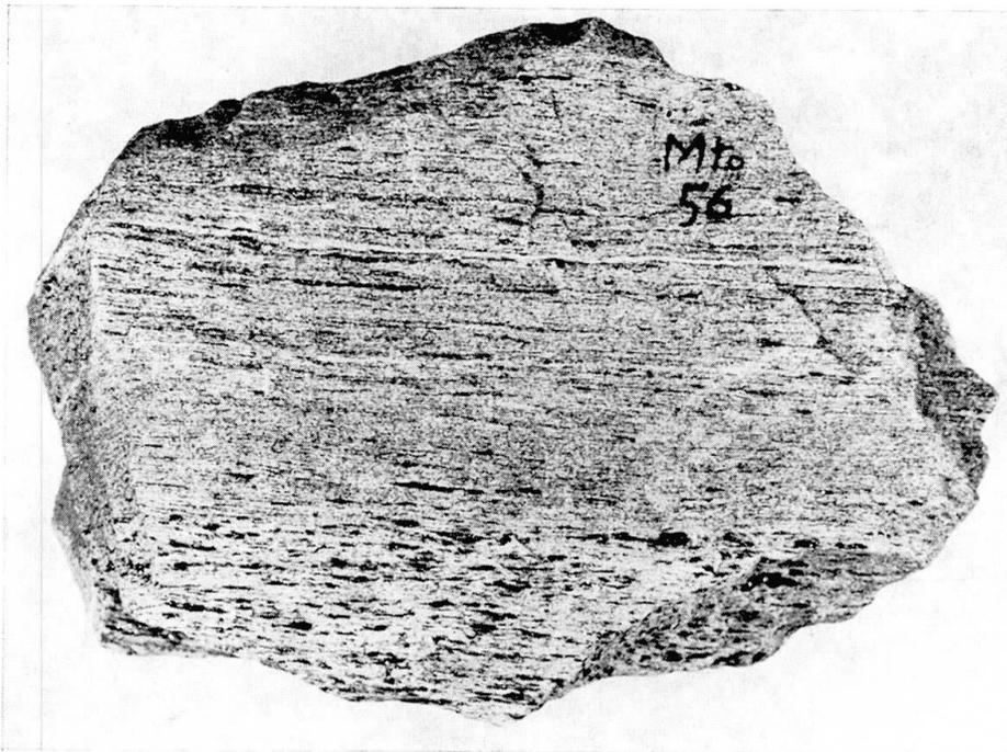
Fig. 11. Block ( $33 \times 57$  cm) von Mto 56: Fein- bis grobkörniges Nebengestein mit Biotit-, Quarz- und Quarzfeldspatnestern im Streichen und quer dazu übergehend in grobkörnig-granitoiden Matorello-Gneis. Fundort: Westufer des Lago Sambuco (Koord. ca. 692.55/146.65).
