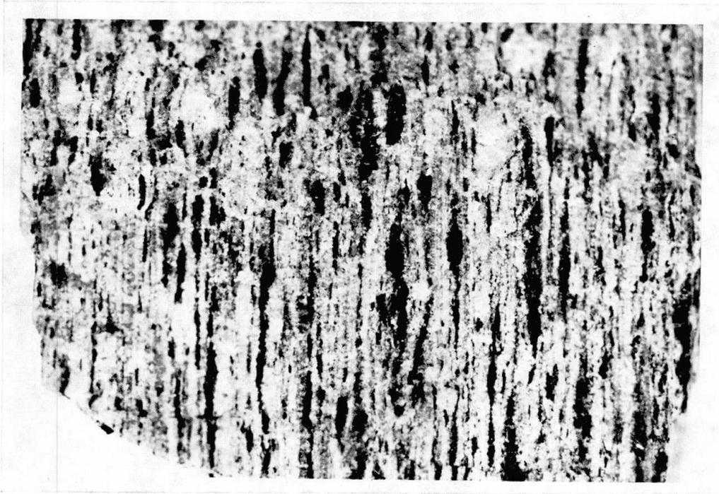
Fig. 10. Anschliff von Matorello-Gneis Mto 891a. Grösse:  $5 \times 7$  cm. Der bc-Schnitt zeigt //s ausgezogene Biotitnester, Quarz- und Quarzfeldspatkornzeilen wie auch Feldspatporphyroblasten und Quarzkörner, welche Biotitlagen korrodieren. Fundort: Steinbruch WNW P. del Lago Scuro, S Lago di Naret (Nähe Fundort der Serie 4, vgl. Tafel 1). Kote ca. 2420 m (Koord. ca. 678.0/147.4).
