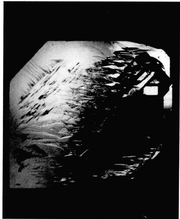
Fig. 6. Prismenfläche mit gitterförmiger Streifung (links), Parkettierung (Mitte) und beginnender Fensterbildung (rechts). Grösse: 14 mm.
