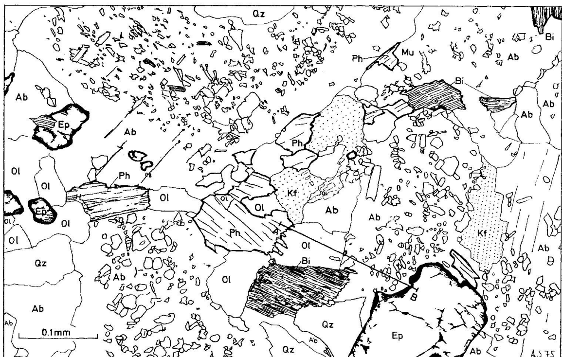
Fig. 5. Dünnschliffsskizze der Rotondogranitgneissprobe AS Ro 132. Das präexistierende magmatische Plutonitgefüge ist an den Albitpseudomorphosen nach präexistierenden, hypidiomorphen Granit-Plagioklasen noch gut zu erkennen. Als Umwandlungsprodukte enthalten diese «gefüllten Feldspäte» Phengit, Biotit, Epidot und selten Granat. Auf den Korngrenzen der präexistierenden Altkörner sind später, d. h. während der progressiven Metamorphose, Quarz, Oligoklas, Albit, Phengit, Biotit und Epidot in einem polygonalen Gefüge und eindeutig grobkörniger als die bei niedriger Temperatur zuerst gewachsenen Phengite, Biotite und Epidote in den saussuritisierten Plagioklasen neu kristallisiert. Beim Betrachten eines solchen typischen Orthogneisgefüges ist es mir ein Rätsel, wie HAFNER (1958) und andere den Rotondogranit als unmetamorphes Tiefengestein bezeichnen konnten.
