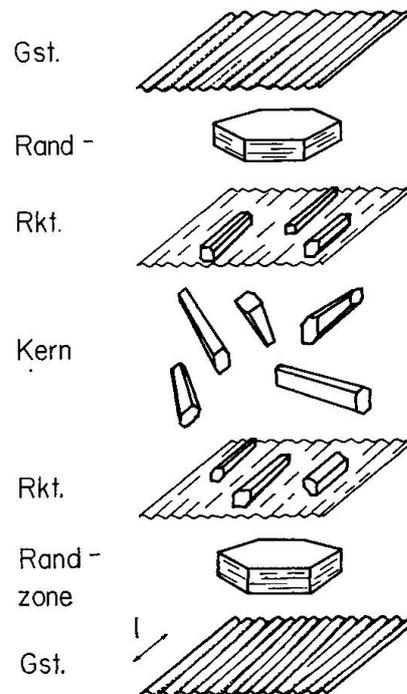
Fig. 8. Zentraler Knauerschnitt mit schematischer Darstellung der Orientierung spezifischer Mineralien. Pseudo-hexagonale Kristalle: Biotit, triklinen Prismen: Disthen.
