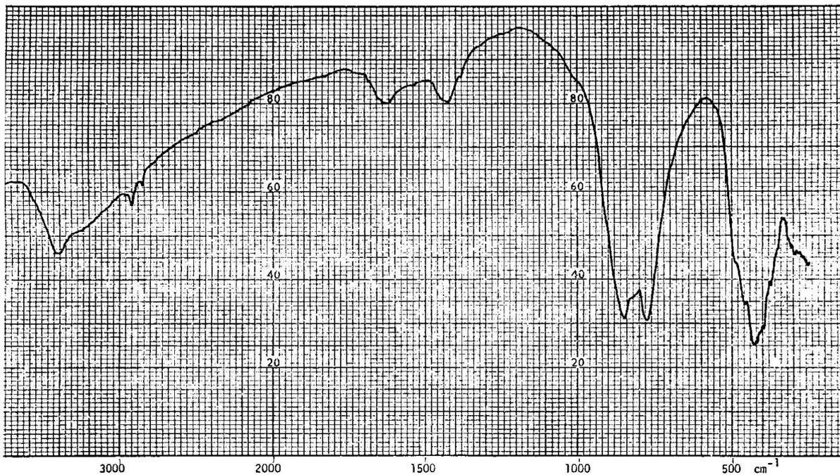
Fig. 2 Infrarot-Spektroskopie-Aufnahme an Grischunit (KBr-Pressling, IR-Spektrophotometer Perkin-Elmer Mod. 598).
