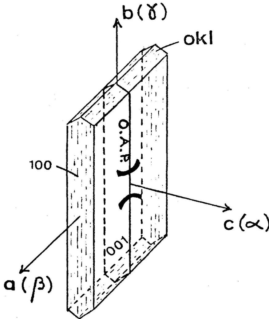
Fig. 2 Habitus d'un cristal d'orthoserpiérite avec les formes principales et la position des éléments optiques. O.A.P. // (100).
