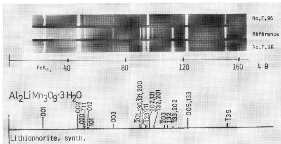
Fig. 8 Variation des diagrammes Guinier en fonction de la teneur en Co et Ni: seules les réflexions 130, 131, 200 et 133, 202 varient. Le réseau cristallin ne semble pas changer de manière importante. Le Co et Ni se trouvent donc en solution solide dans la lithiophorite.
