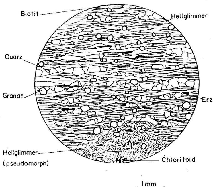
Abb. 15 Eine der Formen des *Glimmerschiefers* (HP-202). Unten ist eine der im Nordwesten des Kartiergebiets typischen Chloritoid-Hellglimmer-Pseudomorphosen zu erkennen. Nach welchem Mineral diese gebildet worden sind, war weder im Dünnschliff noch mit GANDOLFI-Röntgenaufnahmen festzustellen. (Km-Koord.: 2626N/0345E)
